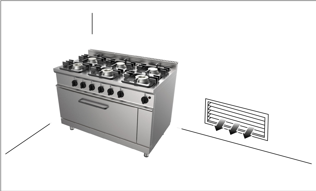
Abb. 26 Belüftung des Installationsraums
