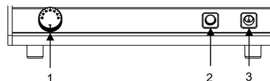
1. Thermostat, wenn in Position "0", sind die Heizelemente ausgeschaltet.
